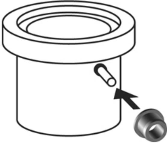
Mit diesem Adapter für HT-Rohrverbindungen kann der am SIH vorinstallierte Kondensatablauf an eine HT-Wasserleitung (DN 40) angeschlossen werden.
