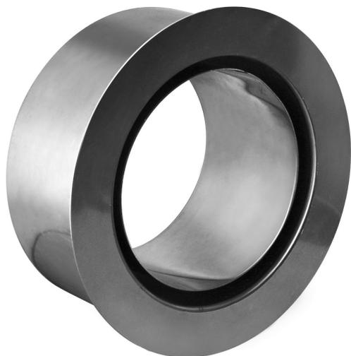
Für den einfachen Anschluss eines Kaminofens oder auch einer Zentralheizung an den Schornstein kann ein Anschlussfutter verwendet werden. Das Anschlussfutter reduziert den größeren keramischen Rauchrohranschluss auf einen dem Anschluss der Feuerstätte/Heizung entsprechenden Querschnitt.
