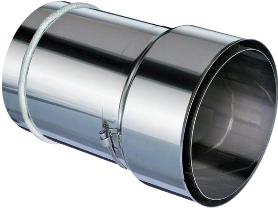
Das Produkt Anschlussübergang mit Doppelwandfutter aus Edelstahl (bei Vormauerung) dient dem Anschluss bzw. Übergang eines Ofenrohres bzw. Rauchrohres an einen Schornstein. Der Anschlussübergang ist in verschiedenen Durchmessern erhältlich und kann bei Bedarf gekürzt werden (vor allem für Wanddurchführungen).
