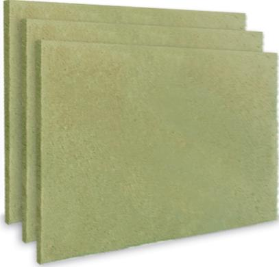
Die nur 5 mm dicke, nicht brennbare Schiedel Bauteil-Trennplatte (Außenmaß 33 x 50 cm) ist zur Sicherstellung der notwendigen Beweglichkeit von Schornstein- bzw. Abgassystemen in statisch eingespannten Decken- und Dachbereichen konzipiert die dann bauseits mit Beton verschlossen werden.
