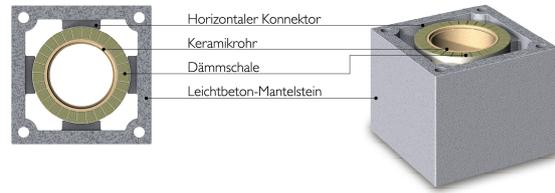
Eine Isoliermatte die zur Dämmung beim Schornstein SEK benötigt wird. Sie verbessert die Wärmedämmung, dient als Kondensatschutz sowie zur gleichmäßigen Temperaturverteilung. Die Dämmung ist in den Durchmessern 16 cm, 18 cm und 20 cm erhältlich. Die Höhe beträgt 33 cm.
