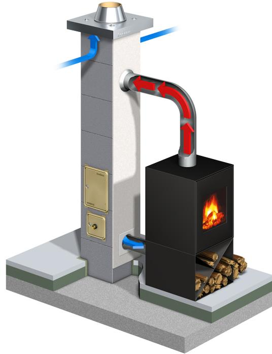
Die Edelstahlzuluftplatte eignet sich für das Schornsteinsystem SEK in den Durchmessern 16, 18 und 20 cm. Die Zuluftplatte wird mit einem passenden Befestigungsset geliefert. Die Zuluftplatte ist mit einem Überstand von 8,5 cm und 11,5 cm lieferbar.
