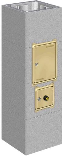
Der Fertigfuß für den SEK ist komplett vormontiert für eine schnellere, sicherere und einfachere Verarbeitung. Ein Kondensatanschluss zur bauseitigen Ableitung ist bereits im Fuß integriert. Der Fertigfuß ist lieferbar für SEK Schornsteinanlagen in den Durchmessern 16, 18 und 20 cm.
