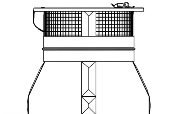
Die Regenhaube dient dazu, das Eindringen von Feuchtigkeit in den Schornstein ABSOLUT, z.B. durch Schlagregen, zu verhindern. Die Regenhaube ist aufklappbar und wird über den Konus auf der vorgebohrten Edelstahl-Abdeckplatte montiert. Der Funkenschutz dient zum einen zum Schutz vor Austritt von Funkenflug aus dem Schornstein und zum anderen zum Schutz vor Vögeln, die sich im Schornstein einnisten könnten.
