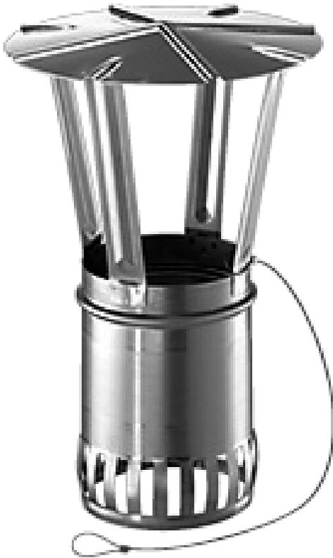
Die Regenhaube mit Sicherungsseil ist der Klassiker der Regenhauben. Sie wird einfach in die Schornsteinmündung gesteckt und mit einem Sicherungsseil an der Abdeckplatte befestigt. Effektiver Schutz gegen das Eindringen von Feuchtigkeit durch die Schornsteinmündung in den Schornstein. Die Regenhaube ist in verschiedenen Durchmessern erhältlich.
