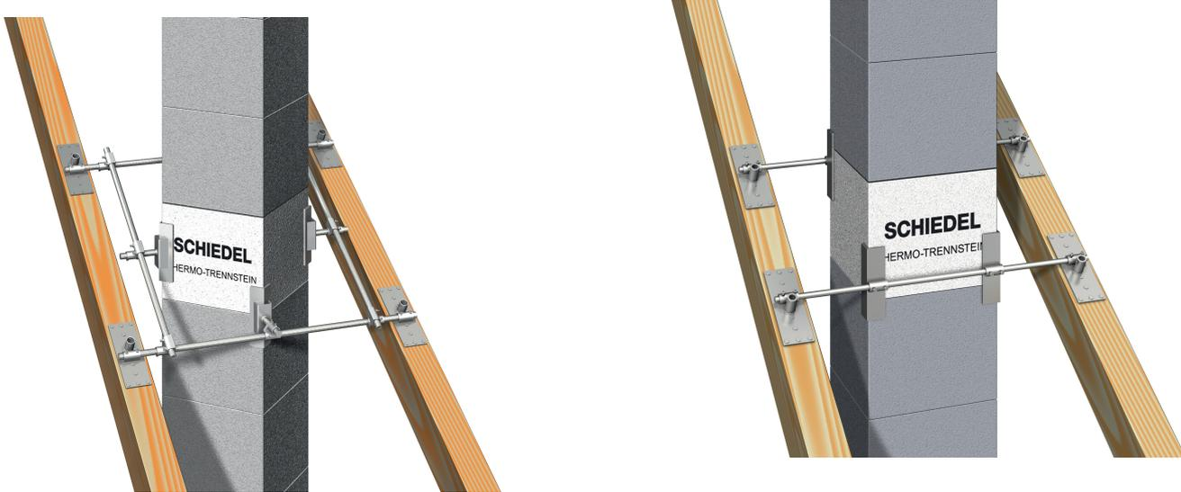
Der Schornsteinhalter für Dach- und Deckendurchführung zur Sicherstellung der Standfestigkeit, Vermeidung von Wärmebrücken, universell für jeden Schornsteintyp und zur variablen Montage auf, zwischen und unter den Sparren.
