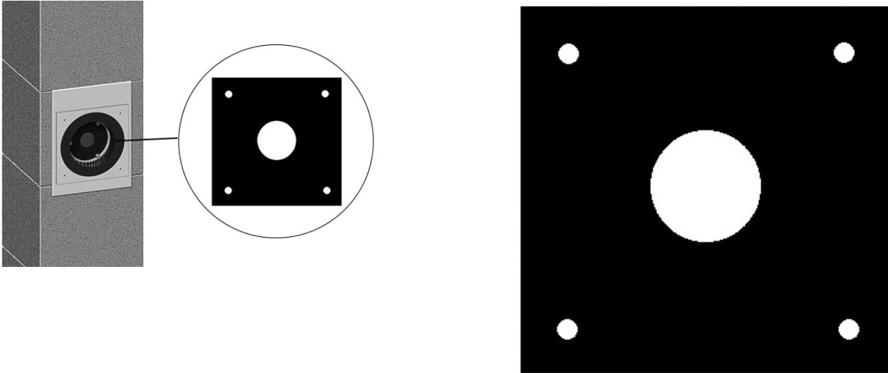
Über die Silikon-Gegenblende wird eine dichte Zulufführung eines konzentrischen Anschlusses sichergestellt. Die Silikon-Gegenblende dient als Ersatzteil für die Rauchrohranschluss-Anschlussblende (Zuluft) und eignet sich für das Schornsteinsystem AVANT.
