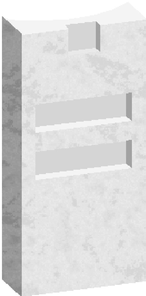
Die Vorsatzschale (12,5 cm x 25,5 cm) wird verwendet, wenn die Reinigung des SIH Schornsteins mit Hilfe einer Putztür vom Dachraum aus vorgenommen werden soll. Um bei Taupunktunterschreitungen Feuchtigkeitsaustritt aus der Putztür zu vermeiden, ist das Anschlussformstück des Schamotterrohres so gestaltet, dass die Öffnung im Innenrohr mit einer zusätzlichen Vorsatzschale verschlossen werden kann.
