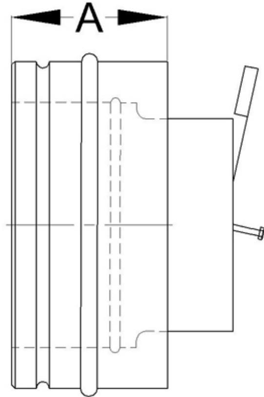
Der Zugbegrenzer mit Explosionsklappe ermöglicht eine regelmäßige Luftbewegung in der Brennkammer sowie eine Erhaltung des Unterdrucks. Durch die integrierte Explosionsklappe ist er gerade für Festbrennstofffeuerstätten geeignet. Das Produkt ermöglicht optimierte Abbrandbedingungen und einen verringerten Brennstoffverbrauch.
