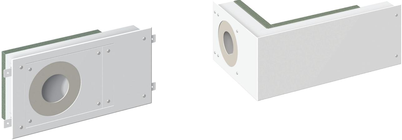
Der Schiedel LAS (Luft-Abgas-Schornsteinsystem) Zuluft-Adapter leitet die Zuluft achsgleich auf den Abgasanschluss um und ermöglicht so einen unkomplizierten Anschluss der raumluftunabhängigen Festbrennstoff Feuerstätte an den LAS-Schornstein. Neben dem Anschluss auf der Längsseite gibt es auch den Anschluss auf der Stirnseite. Die Anschlussöffnung ist variabel für Zuluftführungen von Ø 80 - 130 mm.
